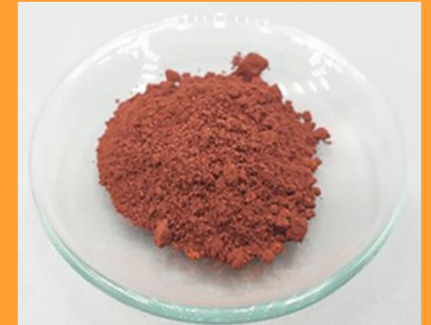
Klärschlammmasche (ca. 12.000 t/a)
